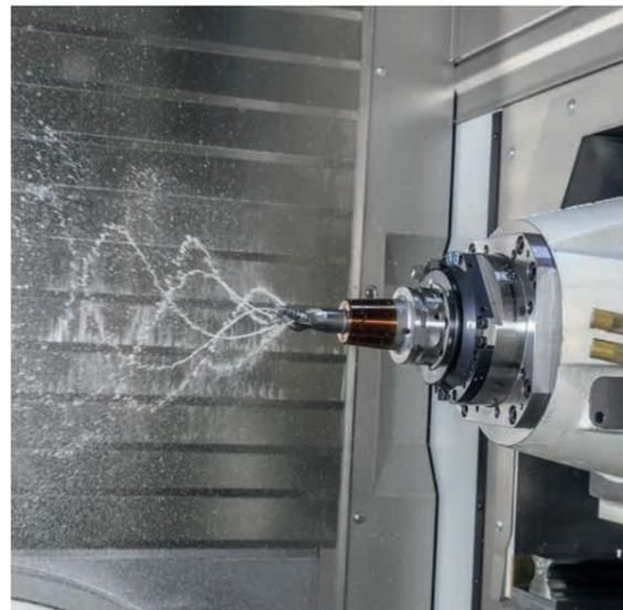
**Späneentsorgung und integrierte Kühlschmierstoffanlage**
