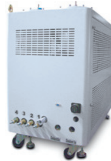
Hochdruckanlage 2 x 70 bar für Haupt- und Gegenspindel, 150 l Kühlmittelbecken, 4 programmierbare Druckstufen
